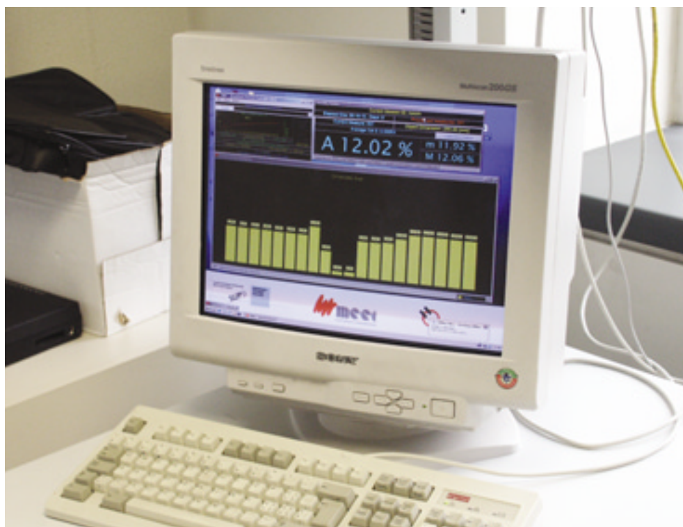
WaveTester Client Software (Windows). Unten im Balkendiagramm die Feuchtemesswerte in Echtzeit, oben links der Editor für die Eichungskurve, oben rechts die numerische Darstellung der Messwerte (Mittelwert, Max, Min, Statistik). (Bild: Elsbeth Heinzelmann)
